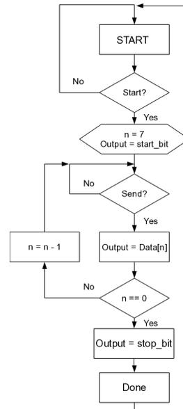
Fig. 5 UART Transmit Process
