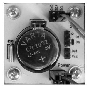
Fig. 5 RTC module [16]
