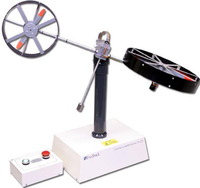
Fig. 1. Twin Rotor MIMO System.
