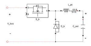
Fig. 4. Buck converter
