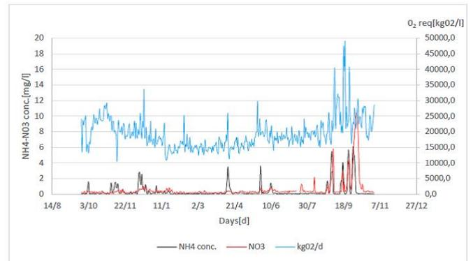
Fig. 6  $O_2$  requirement and effluent  $NO_3/NH_4$
