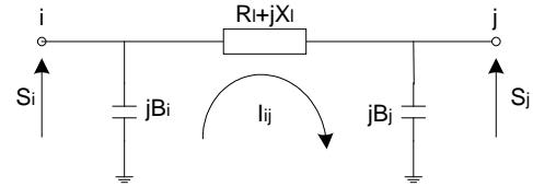
Fig. 1.  $\pi$ -Equivalent Circuit.
