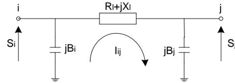
Fig. 1.  $\pi$ -Equivalent Circuit.
