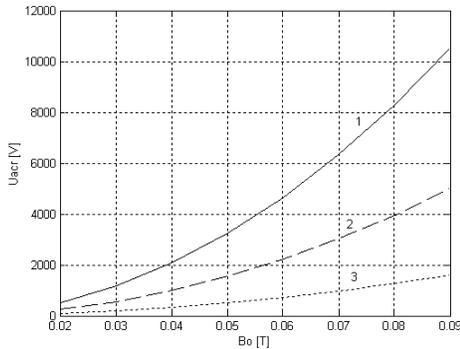
b) Hull's parabolas  $\sigma$ : 1- $\sigma=0,5$ ; 2- $\sigma=0,34$ ; 3- $\sigma=0,25$ ;
