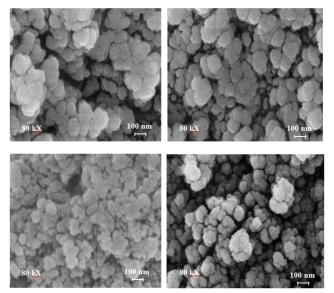
Fig. 3. FESEM images of (a) 10wt%\_9Cu1Ni, (b) 10wt%\_10Cu, (c) 10wt%\_10Ni and (d) TiO<sub>2</sub>
