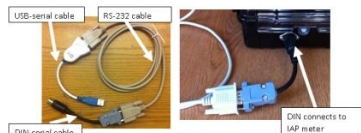
Fig. 18. cables used in IAP meter
