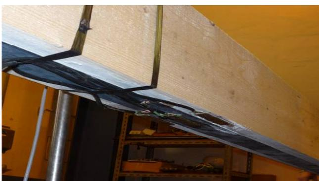
Fig. 4 strain gauges on the bottom (tensile) edge
