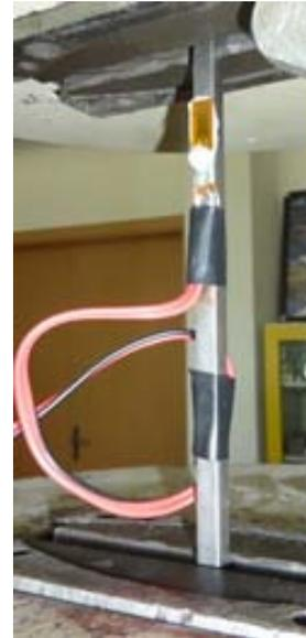
Fig. 3 Bursting test rod
