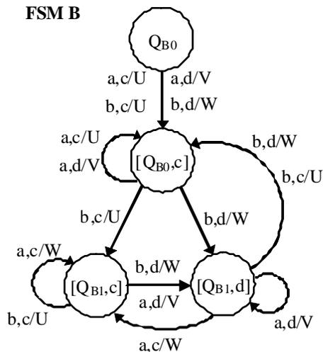
Fig. 9 minimized FSM B
