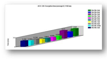
Fig. 7 AES - 128 Encryption time (average 0,11102 ms)
