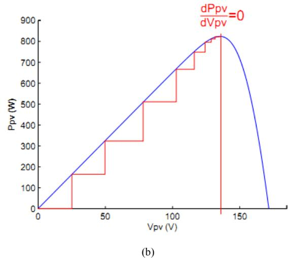
Fig. 7. a) Fixed step, b) variable step[11].
