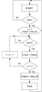
Fig. 5 UART Transmit Process
