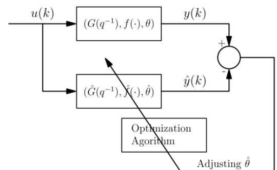
Fig. 2 The principle of parameter estimation
