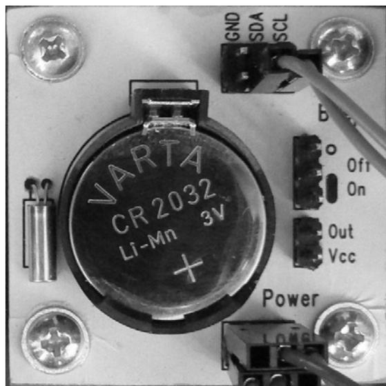
Fig. 5 RTC module [16]
