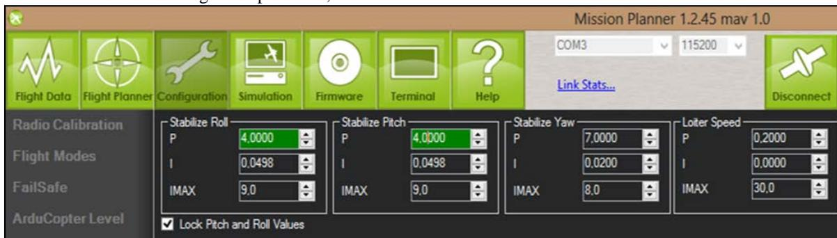
Fig. 14 Setting of  $K_p$  parameter in stabilize roll
