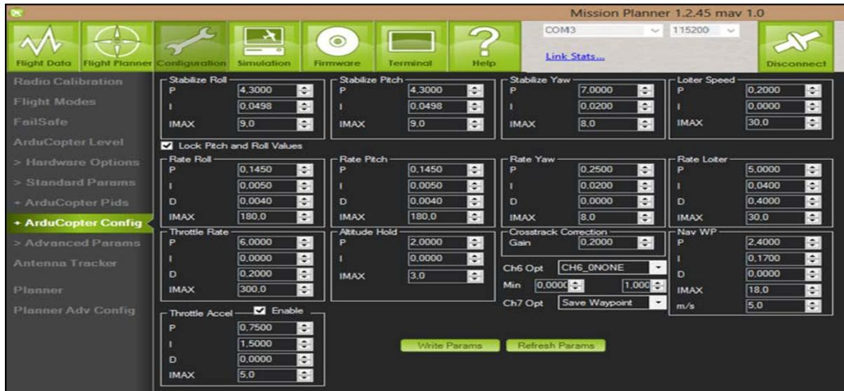
Fig. 13 Initial values of the PID parameters
