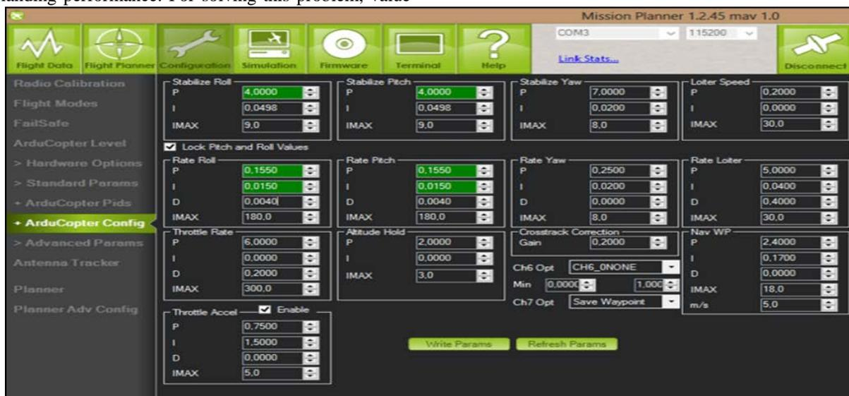
Fig. 15 Setting of  $K_p$  parameter in rate roll
