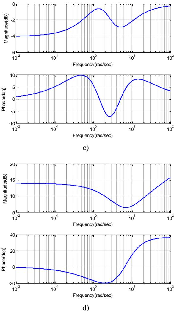
Fig. 3: Bode plots of a)  $C_1(s)$  b)  $C_2(s)$  c)  $C_3(s)$  d)  $C_4(s)$
