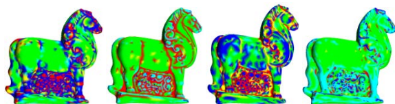
(a) Gauss rate (b) Mean curvature (c) Maximal principle curvature (d) Minimal principal curvature
