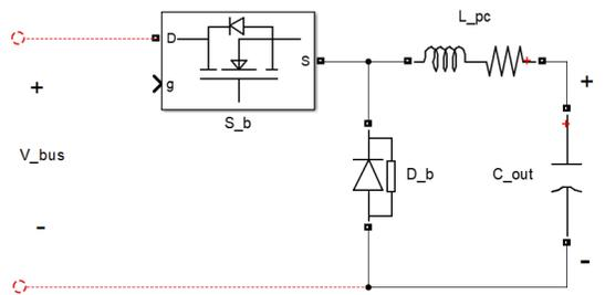
Fig. 4. Buck converter
