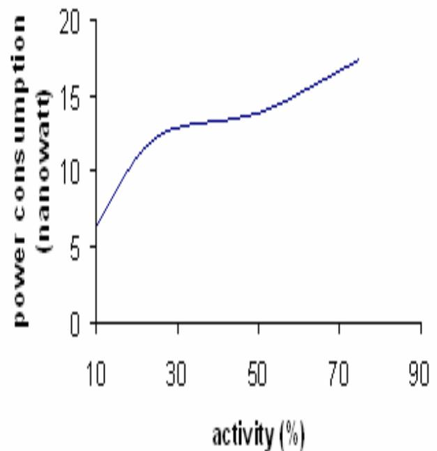
FIG.14 POWER CONSUMPTION VERSUS CIRCUIT ACTIVITY FOR 10-BIT SHIFT REGISTER.
