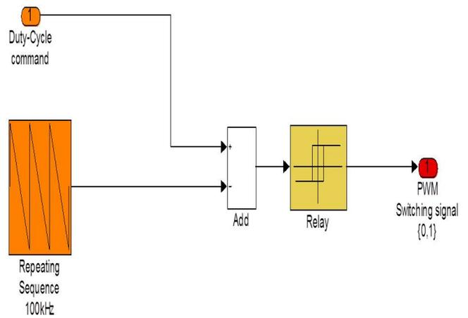
Fig. 4. PWM-Simulink-Block
