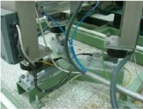
Fig. 6 loadcell
