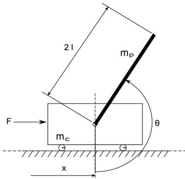
Fig. 1. Cart pendulum.
