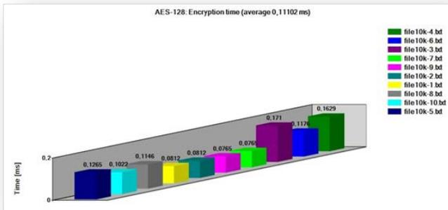
Fig. 7 AES – 128 Encryption time (average 0,11102 ms)
