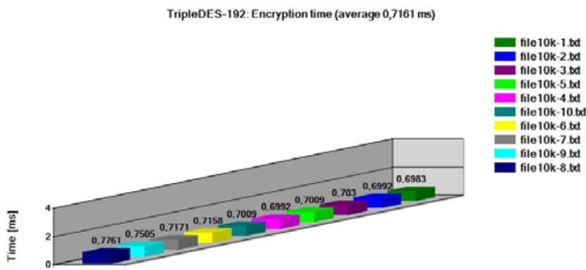
Fig. 12. TripleDES - 192 Encryption time (average 0,7161 ms)
