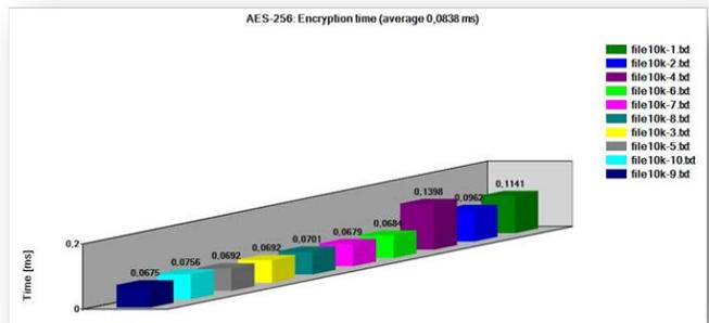
Fig. 9 AES – 256 Encryption time (average 0,0838 ms)
