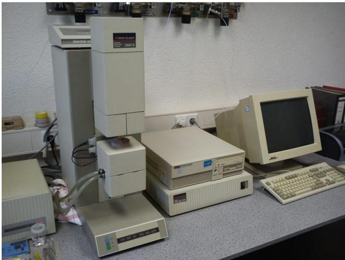
Fig. 5 Perkin Elmer DMA 7e [2]
