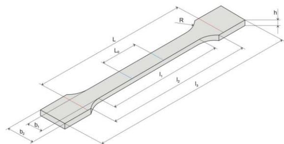
Fig. 10 Testing specimen [28]
